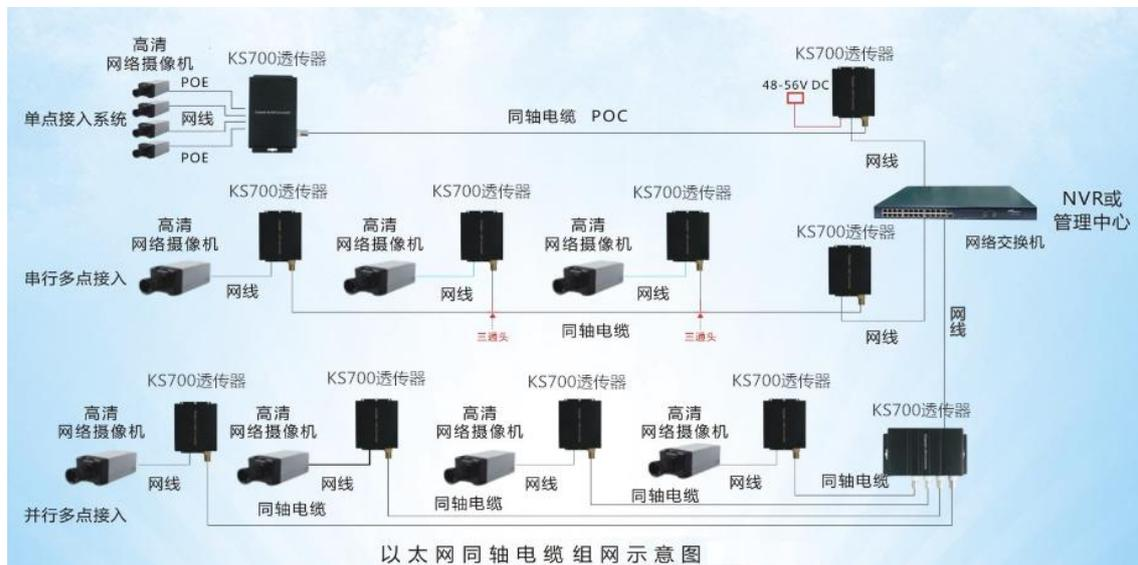
2、在第二种方式里，原有的模拟摄像头通过数字视频服务器（DVS）转化为以太网信号，再按照第一种方式实现联网。目前已经有厂家在实现将视频服务器（DVS）和同轴适配器合二为一的方案，更加简洁灵活。此种方式的优势在于原有的模拟系统不需要变动，也不影响新加入的数字系统，可以实现模拟和数字的共存。
